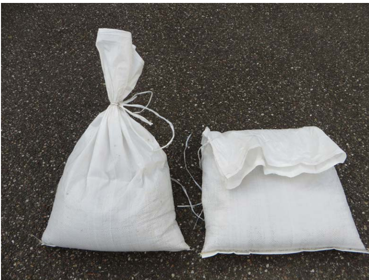
Abb. 6: Sandsack gebunden und umgeschlagen
